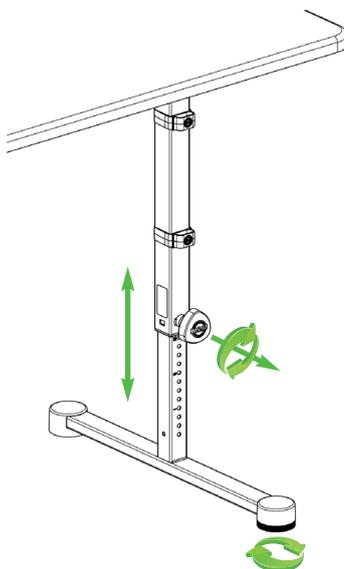
Vorgang auf der gegenüberliegenden Seite wiederholen. Darauf achten, dass beide Füße in der gleichen Position eingerastet sind. Zur besseren Orientierung sind die Bohrungen mit Markierungen versehen.
