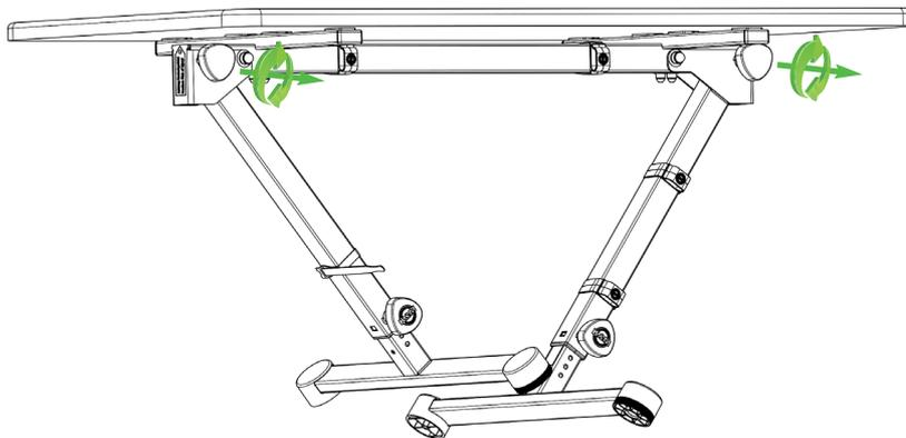
**Tisch aufstellen:** Hierzu müssen die Beine ausgeklappt werden. Das Klettband, welches zur Transportsicherung der eingeklappten Beine dient, entfernen. Die Beine werden nach außen geklappt und mit der Rast-Klemmschraube gesichert. Rast-Klemmschraube lösen, am Griff ziehen und das Bein nach außen schwenken. Griff
