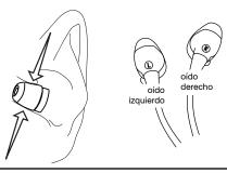
Para sustituir la funda, retire la funda vieja cuidadosamente y deslice una funda nueva sobre la púa de la punta. Si cualquier parte de la punta queda expuesta, la funda no está bien instalada. Reemplace las fundas si no sujetan la punta ajustadamente
