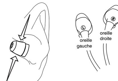
Pour remplacer le manchon, retirer l'ancien avec précaution et enfiler un nouveau manchon par-dessus la barbelure de l'embout. Si une quelconque partie de l'embout est visible, le manchon n'a pas été correctement installé. Remplacer les manchons s'ils ne saisissent pas fermement l'embout.
