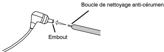
Lors du nettoyage, ne pas faire entrer de force quelque objet que ce soit dans l'embout d'écouteur ! Cela endommagerait le filtre acoustique de l'écouteur.
